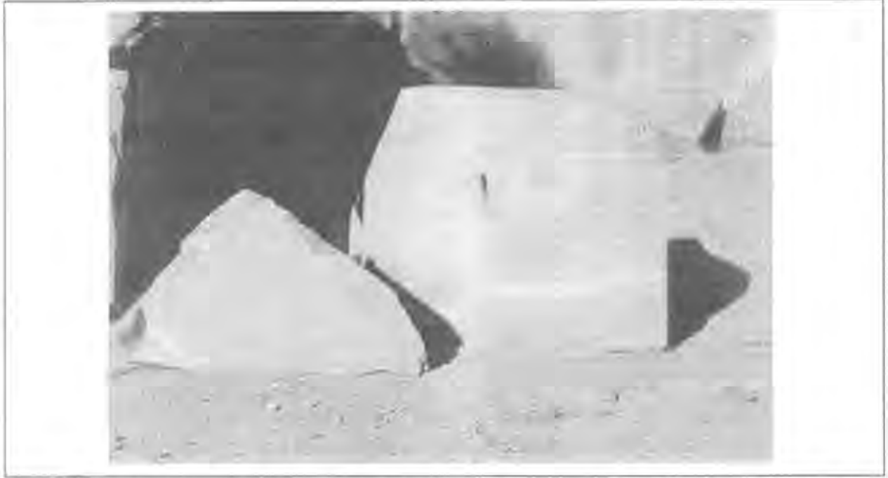
Şekil13: Ege Bordo Mermeri içerisinde gözlenen mika dolgulu makaslama yüzeyleri boyunca kırılmış kaya bloğu.
