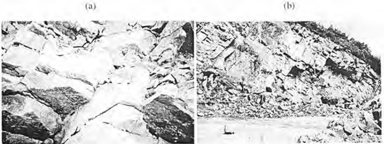
Şekil 5. (a) Kireçtaşı ve (b) kumtaşında gelişmiş süreksizlikler.
