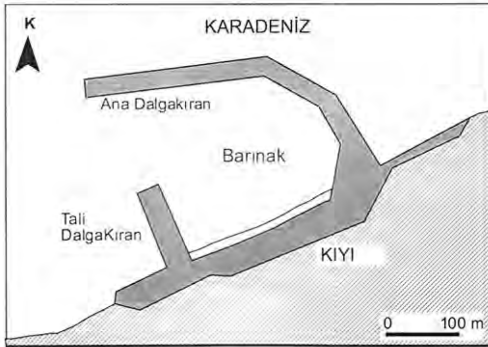
Şekil 1. Heraldı balıkçı barınağı uygulama planı
