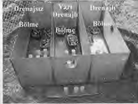
Şekil 3. Muğla-meteoroloji istasyonuna yerleştirilen inceleme tankı ve tank içindeki örnekler.
