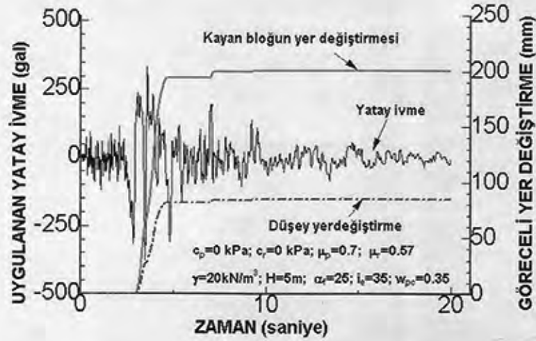
Şekil 18. Davarlı ve benzeri dolgular için hesaplanan yerdeğiştirmeler
