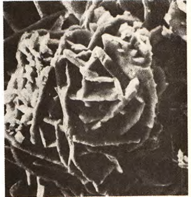
Şekil 1: Taş boşluklarında tuzlanma ile oluşan jips gülü. S.E. Mx 1000 (L.D. CAPİTANİ'den 1976).
