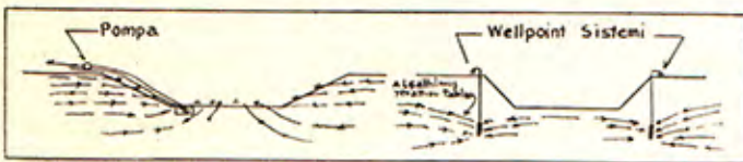
Şekil 2 — Bir kazıda olağan pompalama ile (a) ve well point yöntemi ile su düzeyinin düşürülmesini
