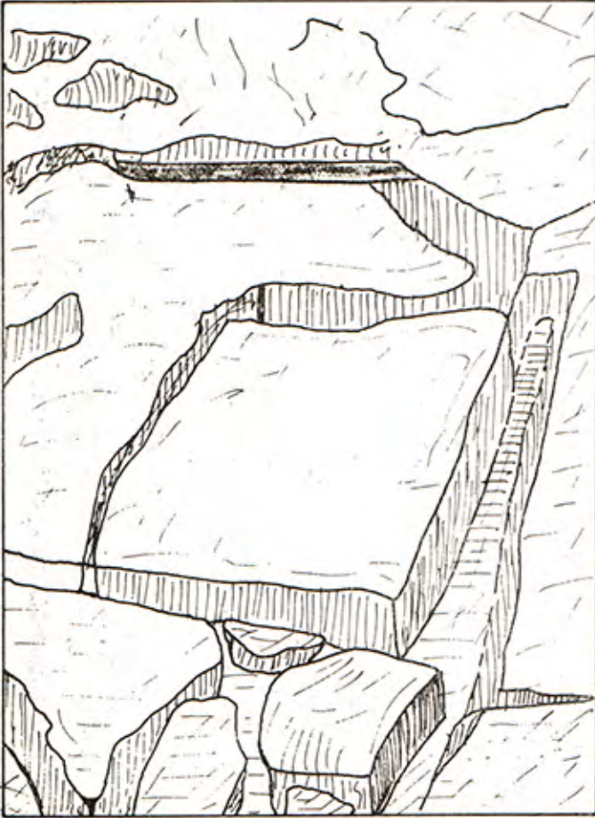
Şekil 2 — Boğazköy-Kestikaya kristalize kalker ocaklarında oluk açma ile blok çıkarma (Hitit M. Ö. II. bin, B. Alkim).
